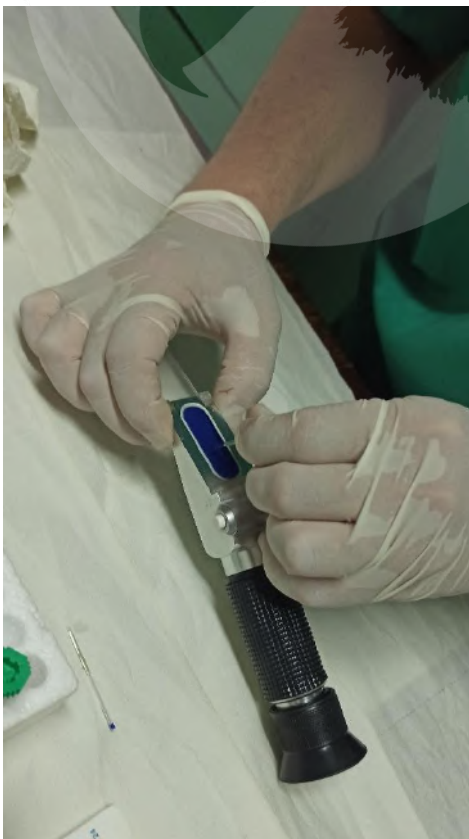
Fig. 46. Colocação do soro no refratômetro para medição dos Sólidos Totais.
